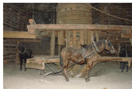
Obrázek 1: Žentour (převod koňské síly na točivý moment na řemenici).
