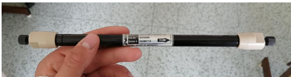
Obrázek 30: Separační katexová kolona LCA K19/Li 4,6 x 210 mm
