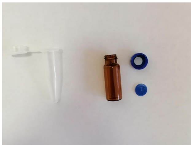
Obrázek 26: Eppendorf mikrozkušavka, Vialka (2 ml) + víčko a septum
