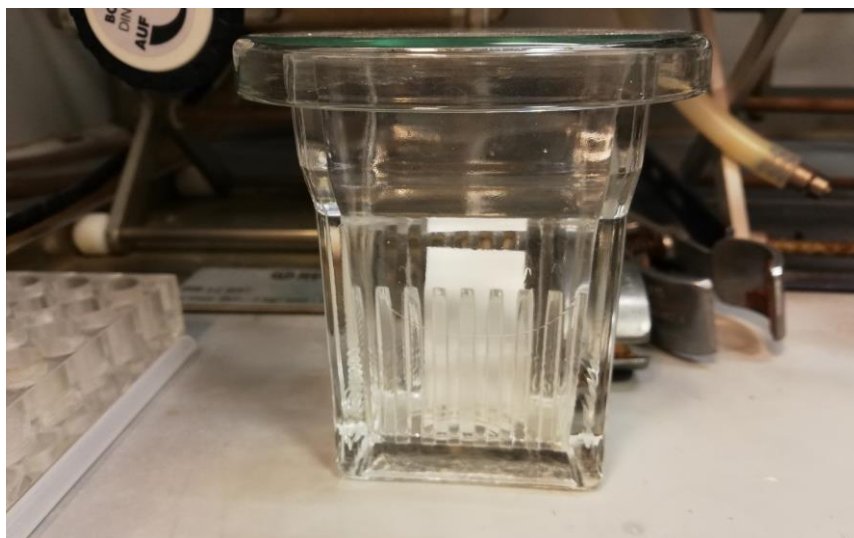
Obrázek 16: Vyvíjecí cela pro TLC s destičkou TLC uvnitř
