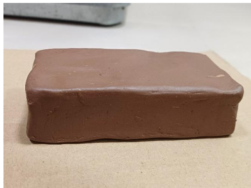
Obrázek 9: Výroba cihlíček pro budoucí mikroskopování: (a, c, e) – s přidavkem plev; (b, d, f) – s přidavkem hnoje.
