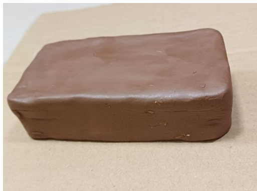
Obrázek 9: Výroba cihlíček pro budoucí mikroskopování: (a, c, e) – s přidavkem plev; (b, d, f) – s přidavkem hnoje.
