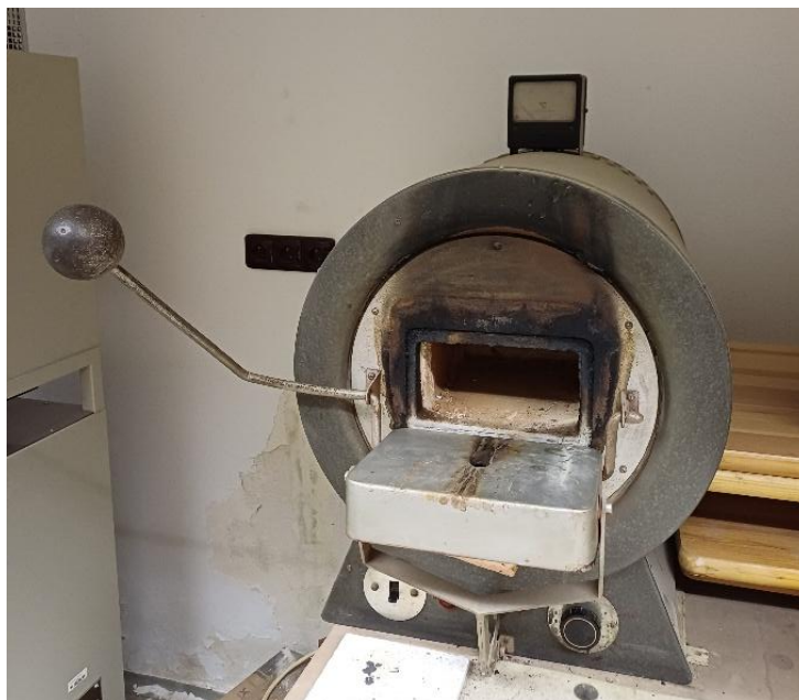
Obrázek 10: Pec použitá k výpalu výbrusových preparátů.
