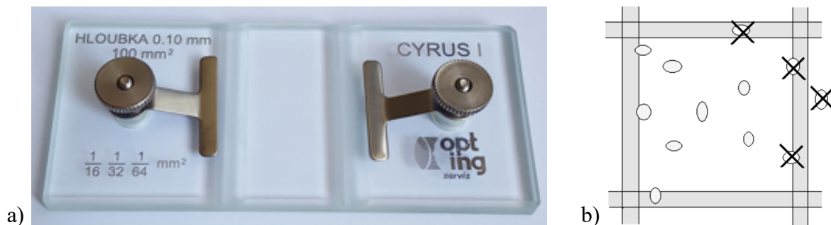
Obrázek 4.9: Bürkerova komůrka. a) Náhled na komůrku, b) počítací políčko.
